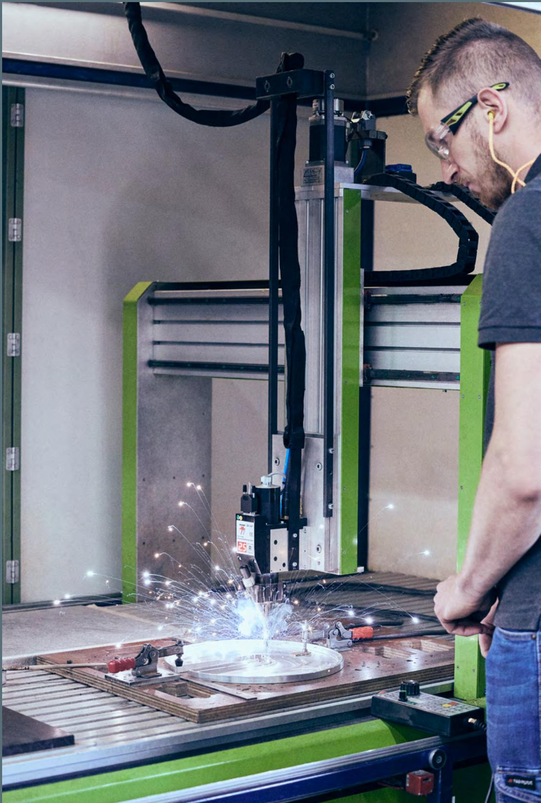
**Punktschweißen:** Im Bild werden drei Bolzen auf den **Naxos-Reflektor** geschweißt. Dies ermöglicht eine sichere Verschraubung der LED-Platinen und gewährleistet deren einfache Austauschbarkeit.
