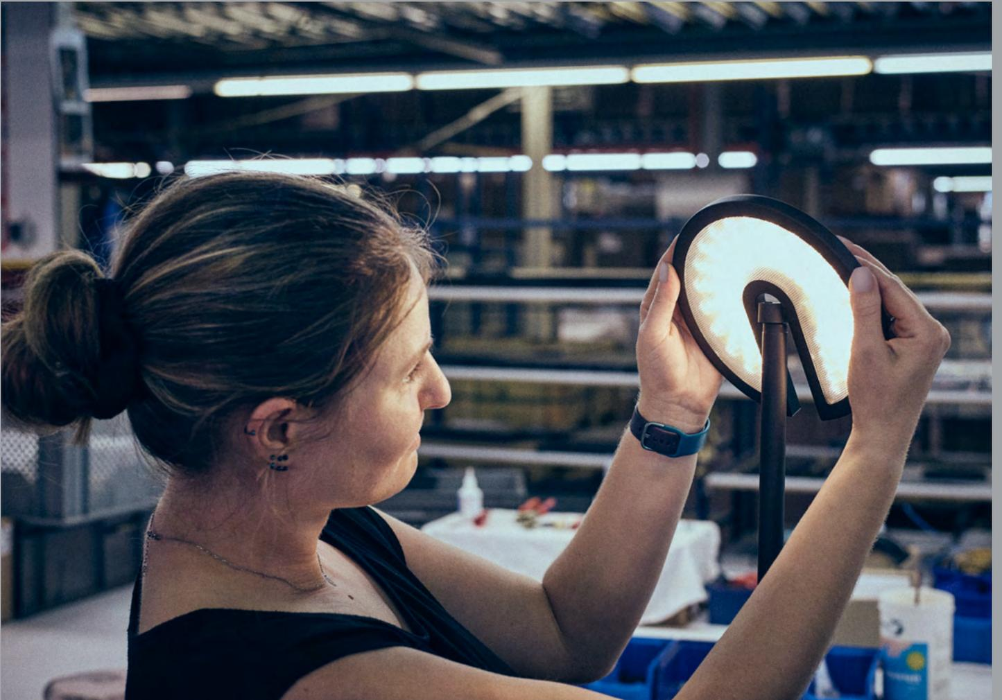
Jede einzelne Leuchte wird vor dem Verpacken auf **Funktionalität** und **elektrische Sicherheit** überprüft.
