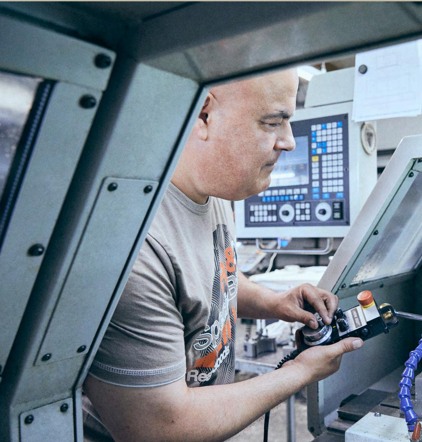
Im **internen Werkzeugbau** entstehen die Werkzeuge, die später in der Serienfertigung unserer Leuchten verwendet werden. Im Bild wird ein Tiefziehwerkzeug für die Strebe der **Plissee-Deckenleuchte** gedreht.
