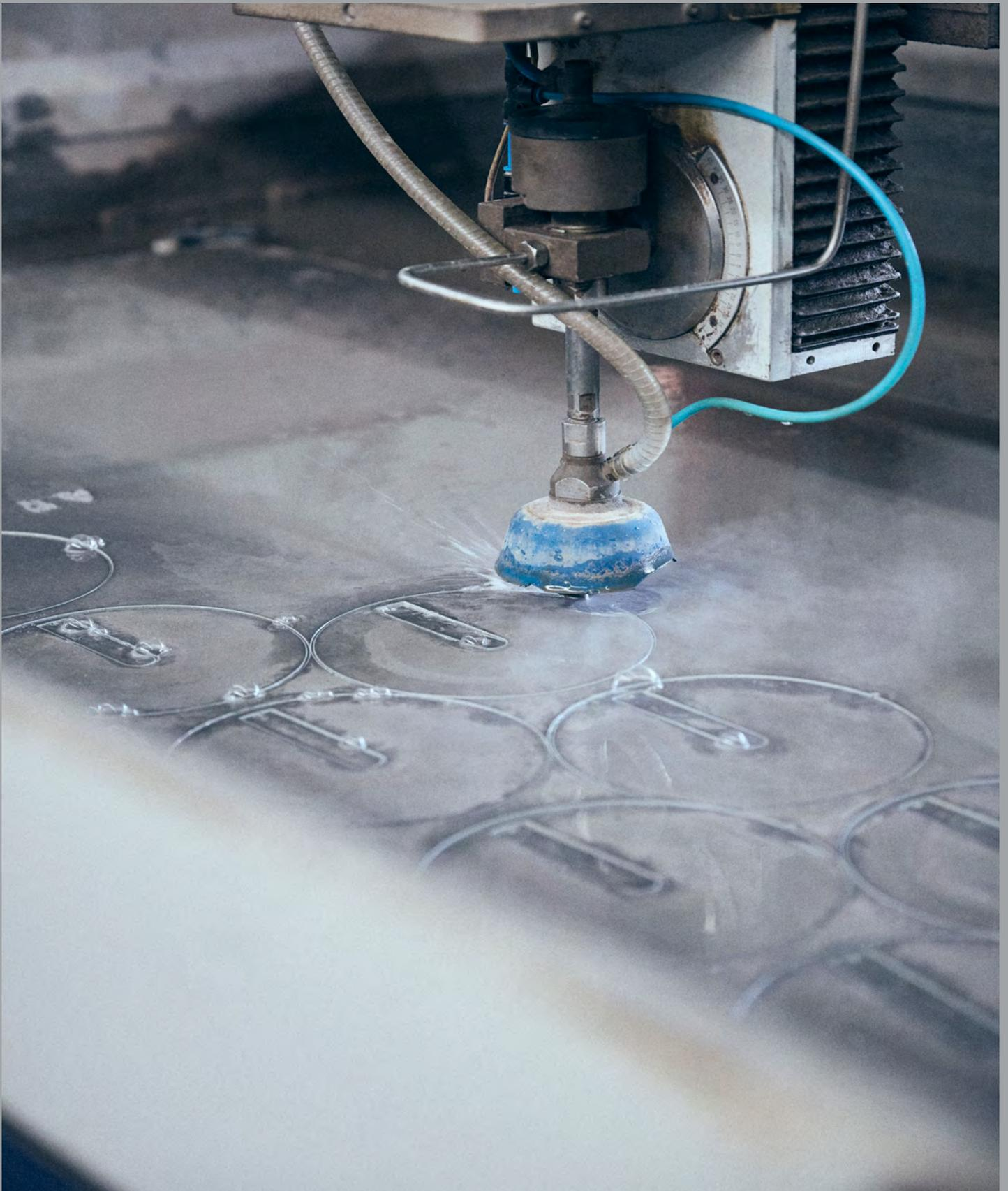
**Präzises Schneiden mit Wasserstrahltechnik:** Mit unserem Wasserstrahler schneiden wir Leuchtenreflektoren aus einer Aluminiumtafel. Der Wasserstrahl, gemischt mit Abrasivpartikeln, schneidet unter Hochdruck das Material präzise und sauber. So entstehen **elegante Reflektoren**, die unseren hohen Qualitätsstandards entsprechen.
