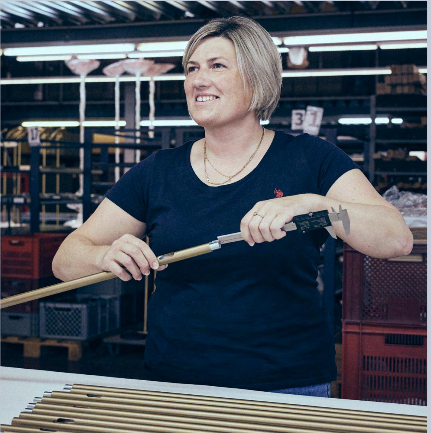
Die **Endmontage** ist der letzte Schritt im Herstellungsprozess. Hier werden alle metallischen und auch elektrotechnischen Bauteile zusammengefügt und zu einer funktionsfähigen Leuchte montiert. Das Gewinde, das das Rohr und den Sockel der **Plano-Leseleuchte** verbindet, muss immer im selben Abstand verbaut werden. So bleibt die Leuchte standfest.
